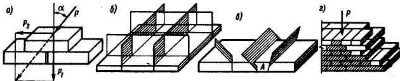
а — воздействие на горизонтальный ряд кладки наклонной силы; б—правильное расположение вертикальных плоскостей разрезки кладки; в —то же, неправильное; г —кладка с перевязкой вертикальных швов
