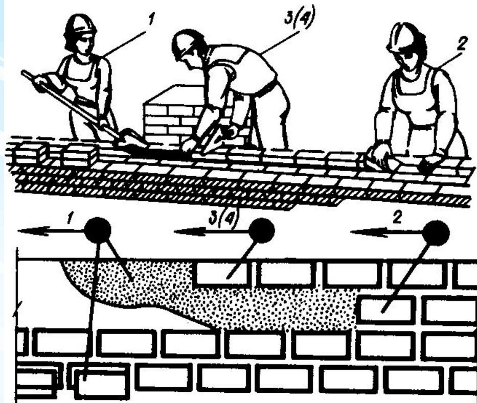
Работа звена «тройки» при кладке наружной ложковой версты, внутренней версты и забутки
