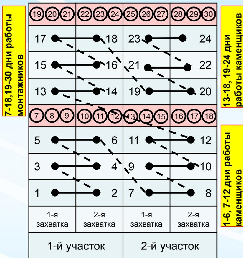
**1.** Последовательная кладка стен на захватках каждого яруса: здание в плане разбивается на две, три и большее число захваток в зависимости от размеров здания и сроков.
