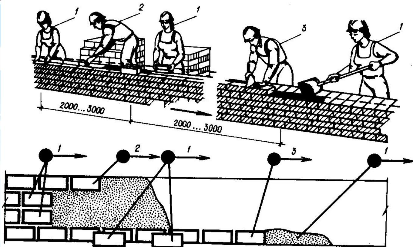
Звеном «пятерка» целесообразно работать при кладке глухих участков стен толщиной более двух кирпичей. При кладке проемов «пятерка» разделяется на два звена — «двойку» и «тройку».
