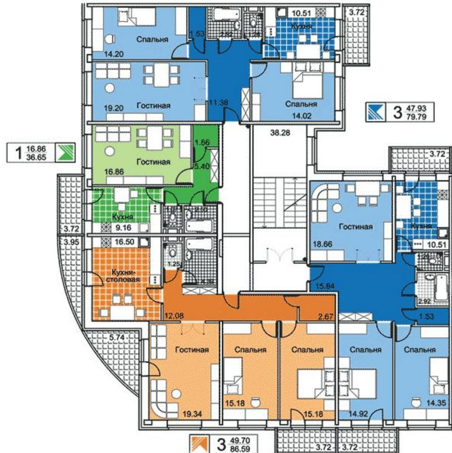
Секции, разработанные специально для узла примыкания двух корпусов (секции – вставки):
