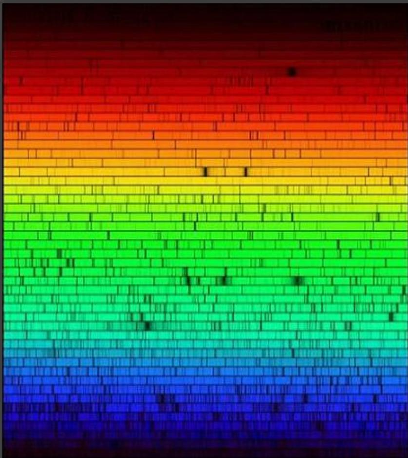
В 1859г **Густав Кирхгоф** (1824-1887, Германия) и **Роберт Бунзен** (1811-1899, Германия) открыли спектральный анализ: *«Газы поглощают те длины волн, которые излучают в нагретом состоянии».*
