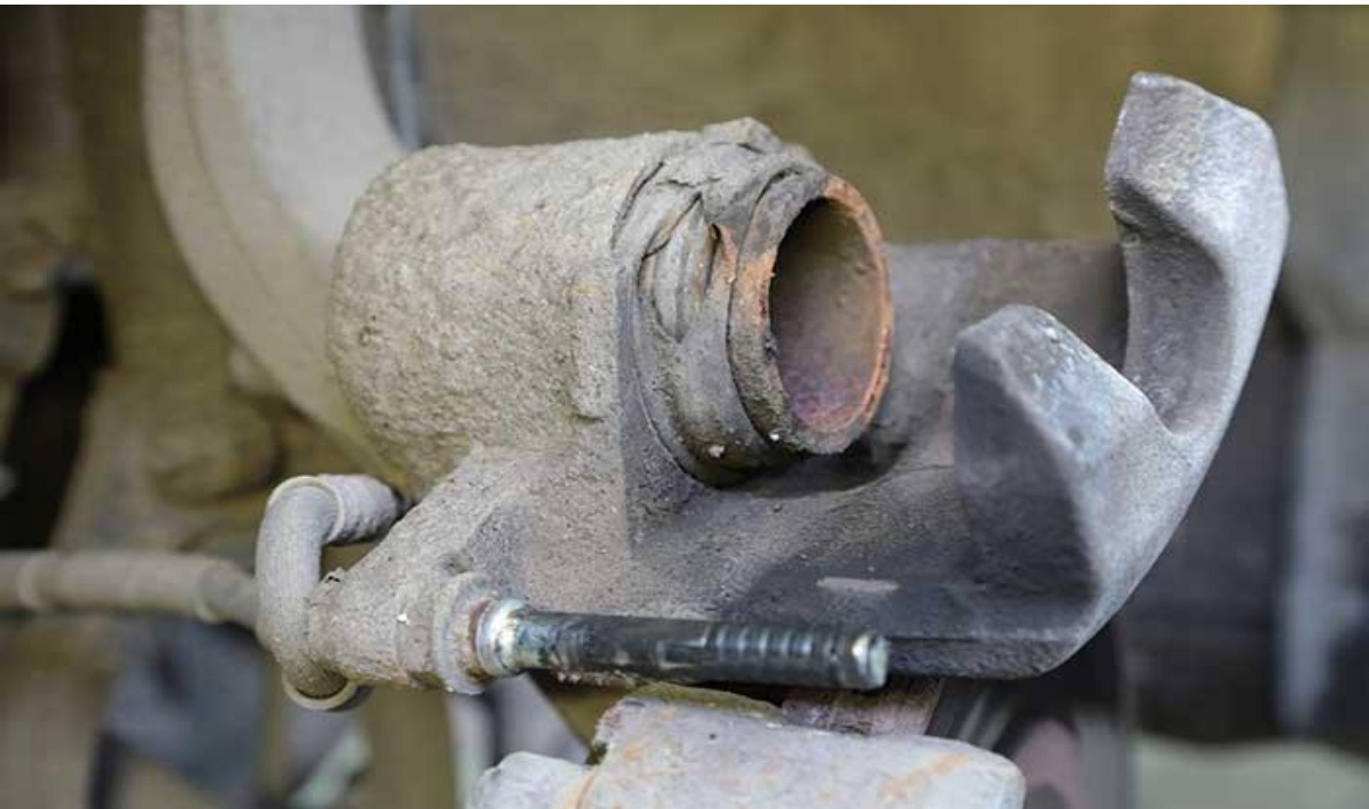
Продолжаем проверять состояние дискового тормозного механизма, снимаем суппорт и проверяем состояние резиновых тормозных шлангов
