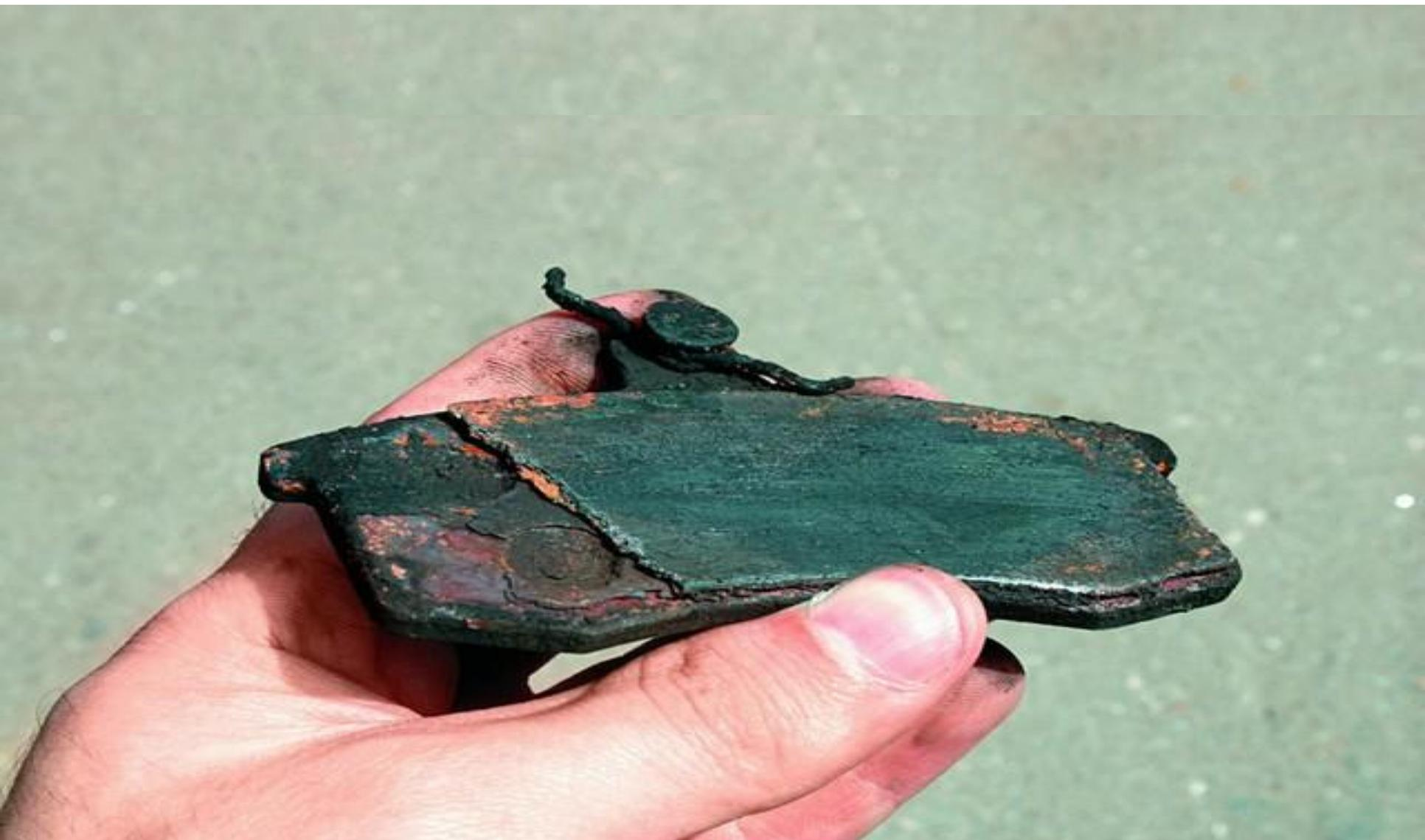
Толщина фрикционного слоя тормозной колодки должна быть не менее 2 мм, если они менее 2 мм, то тормозные колодки подлежат замене
