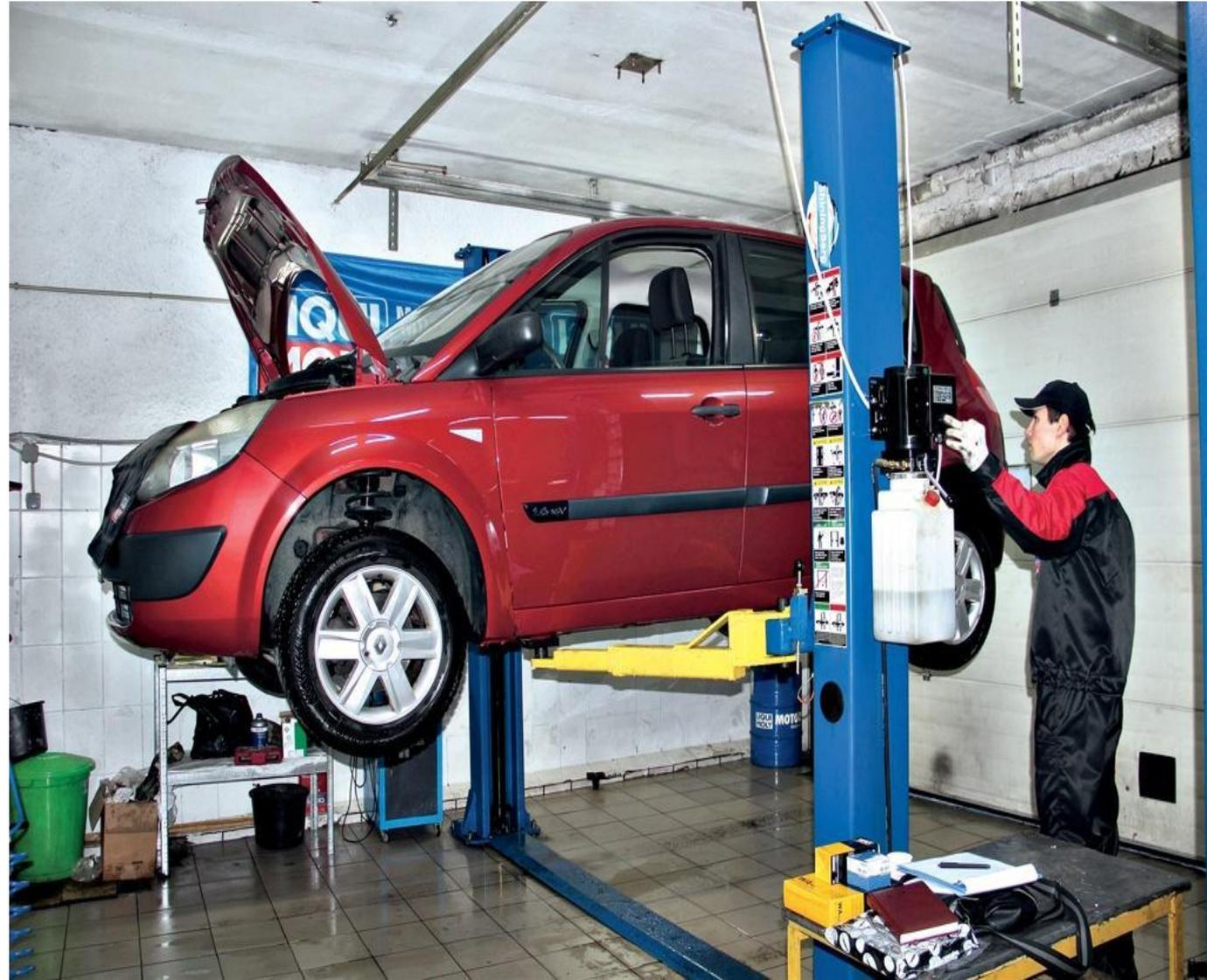
Начинаем с переднего моста . Проверяем люфты ступичного подшипника на переднем правом и левом колесах автомобиля, **руками энергично качаем колесо за верхнюю часть** проверяем наличие люфта
