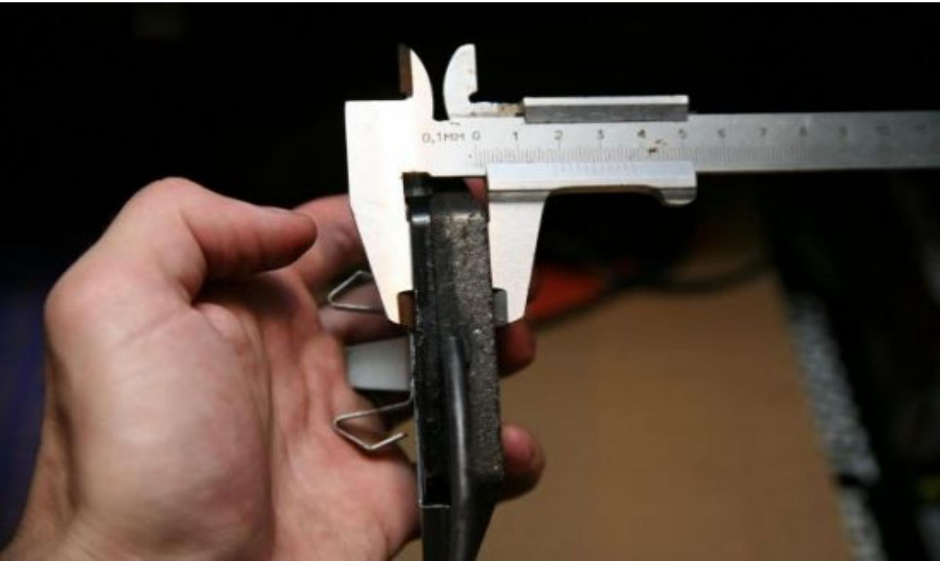
Толщина фрикционного слоя тормозной колодки должна быть не менее ?
