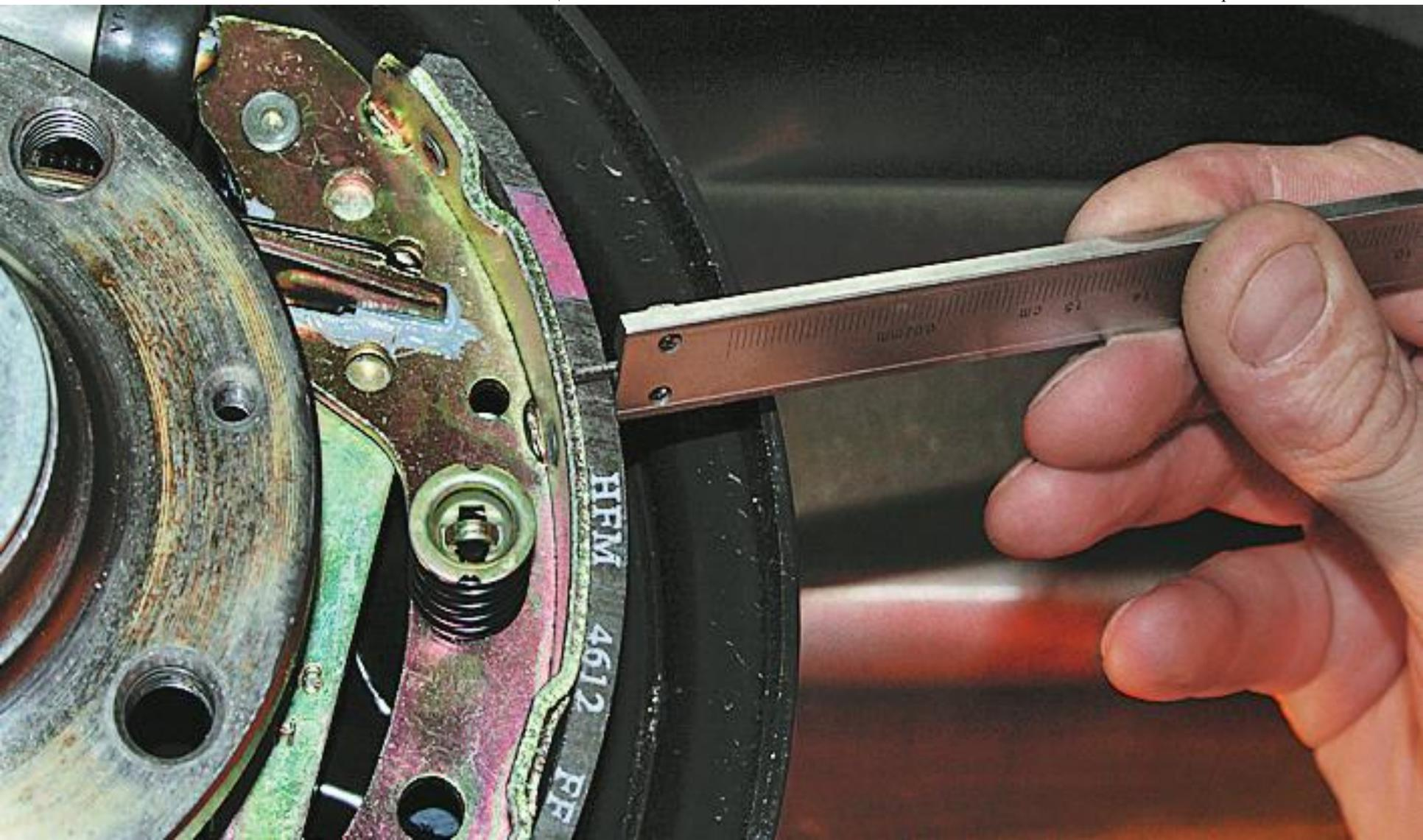
При повышенном износе накладок тормозных колодок до 1,5...2,0 мм для задних и 2 мм для задних тормозов или если в накладках есть дефекты (трещины, сколы и т.д.), тормозные **колодки надо заменить**
