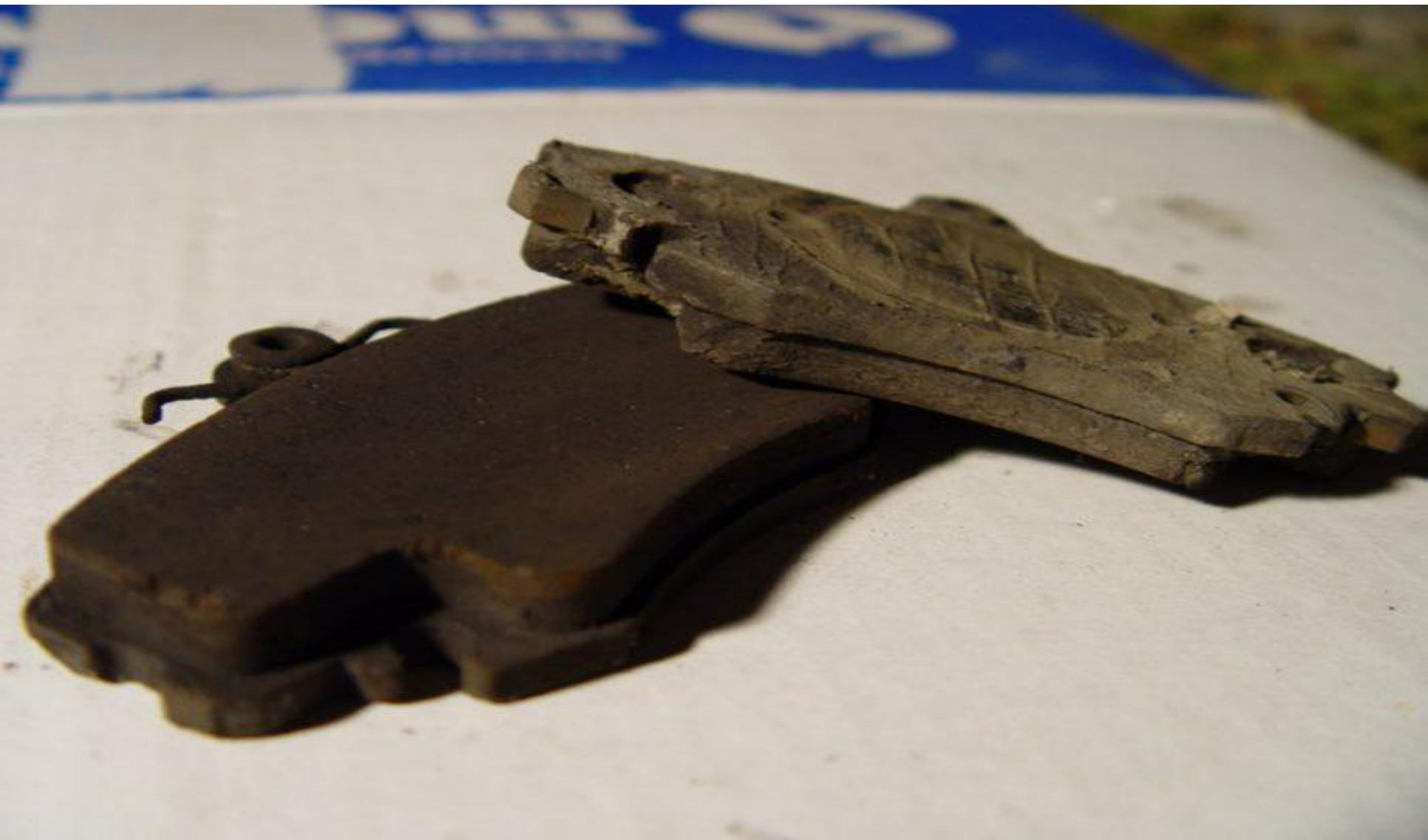
Измерение толщины фрикционного слоя тормозной колодки проводится штангенциркулем, можно и слесарной линейкой
