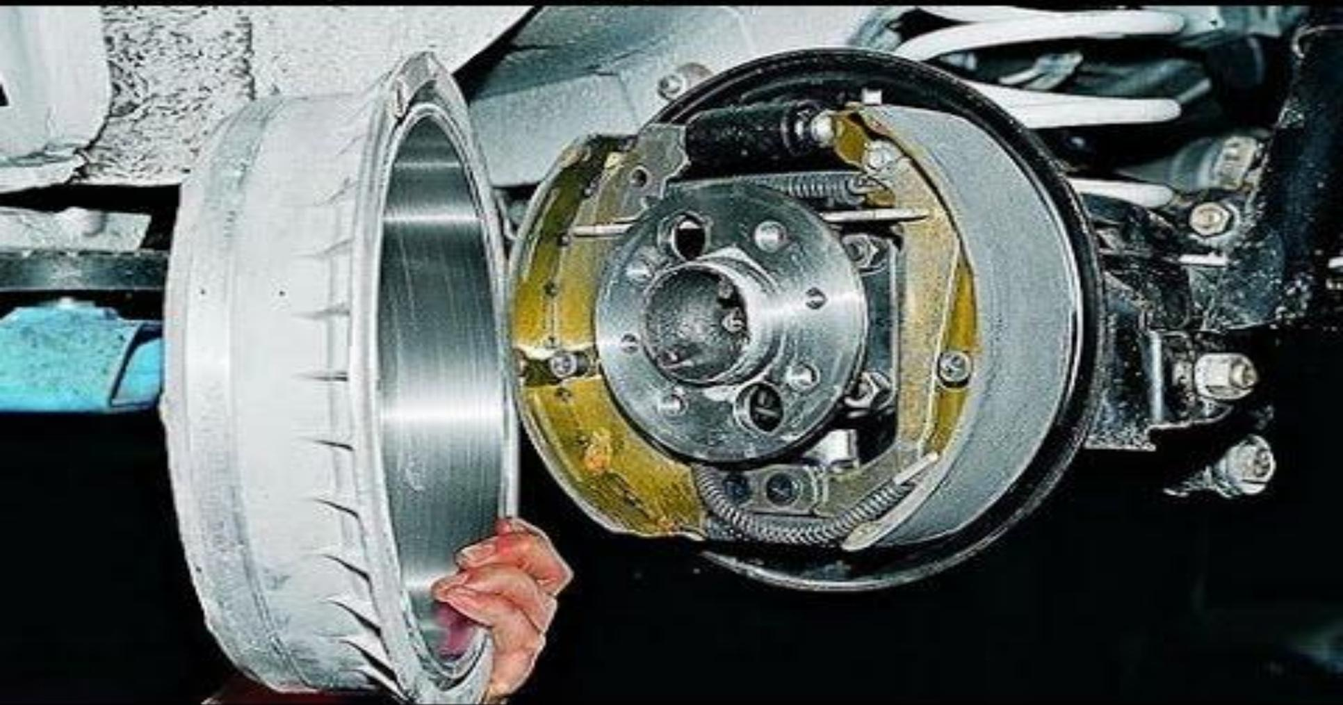
Проверяем тормозной барабан на...целостность, сколы трещины и вненормативный износ, если есть трещины и сколы то тормозной барабан меняем на новый
