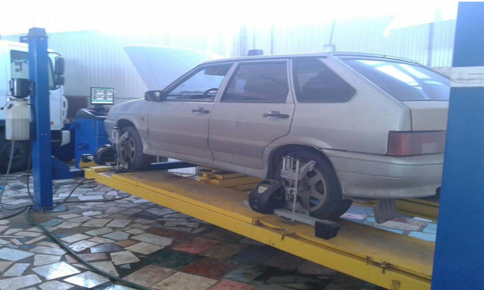
Рабочее место поста диагностики оборудовано: подъемником, набором инструментов, измерительным инструментом (микрометром и штангенциркулем), динамометрическими ключами, стойками, передвижным ящиком с инструментом и технической литературой, в которой есть необходимая информация по выполнению работ, величина затяжки и т.д.
