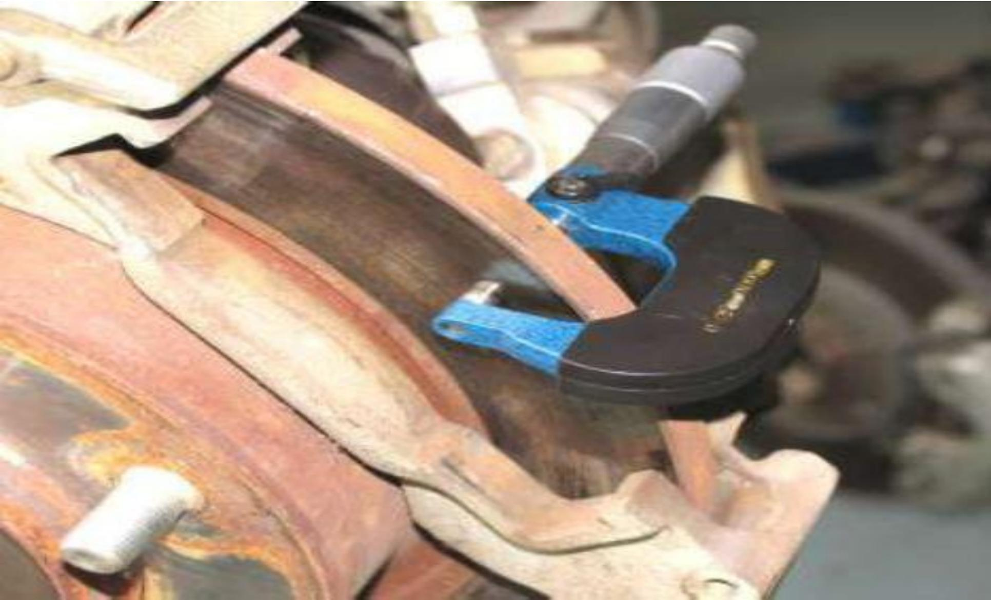
Не менее .....11 мм !!! Если толщина тормозного диска меньше установленного норматива заводом изготовителем то, .....тормозной диск подлежит замене
