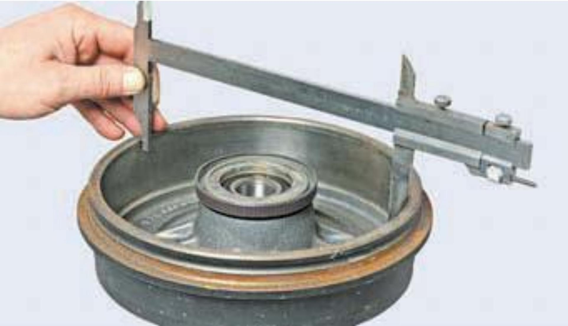
Замеры внутреннего диаметра барабана проводим в нескольких местах, с целью определить наличие у него эллипса (и тогда его точно меняем)
