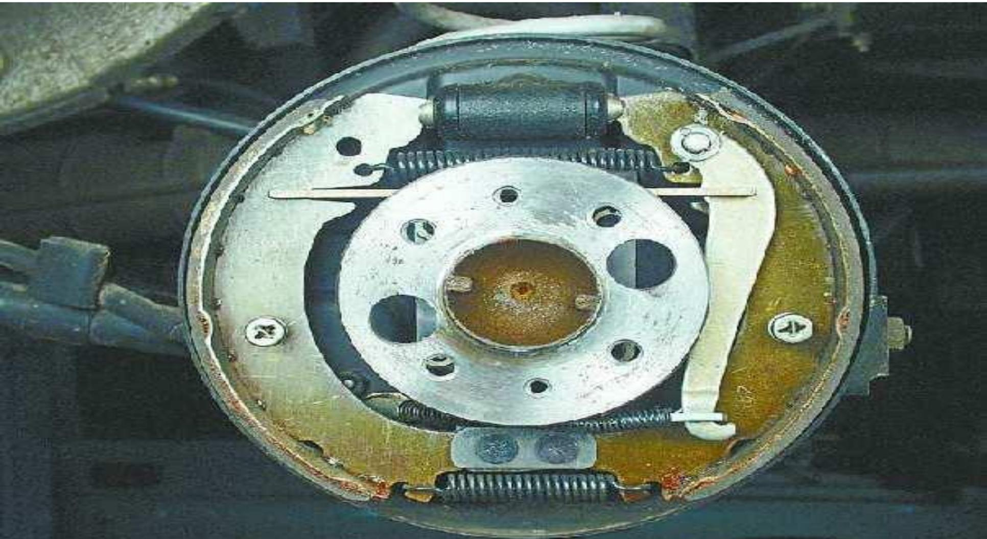
После диагностики тормозного барабана производится диагностика тормозного барабанного механизма, а именно:
