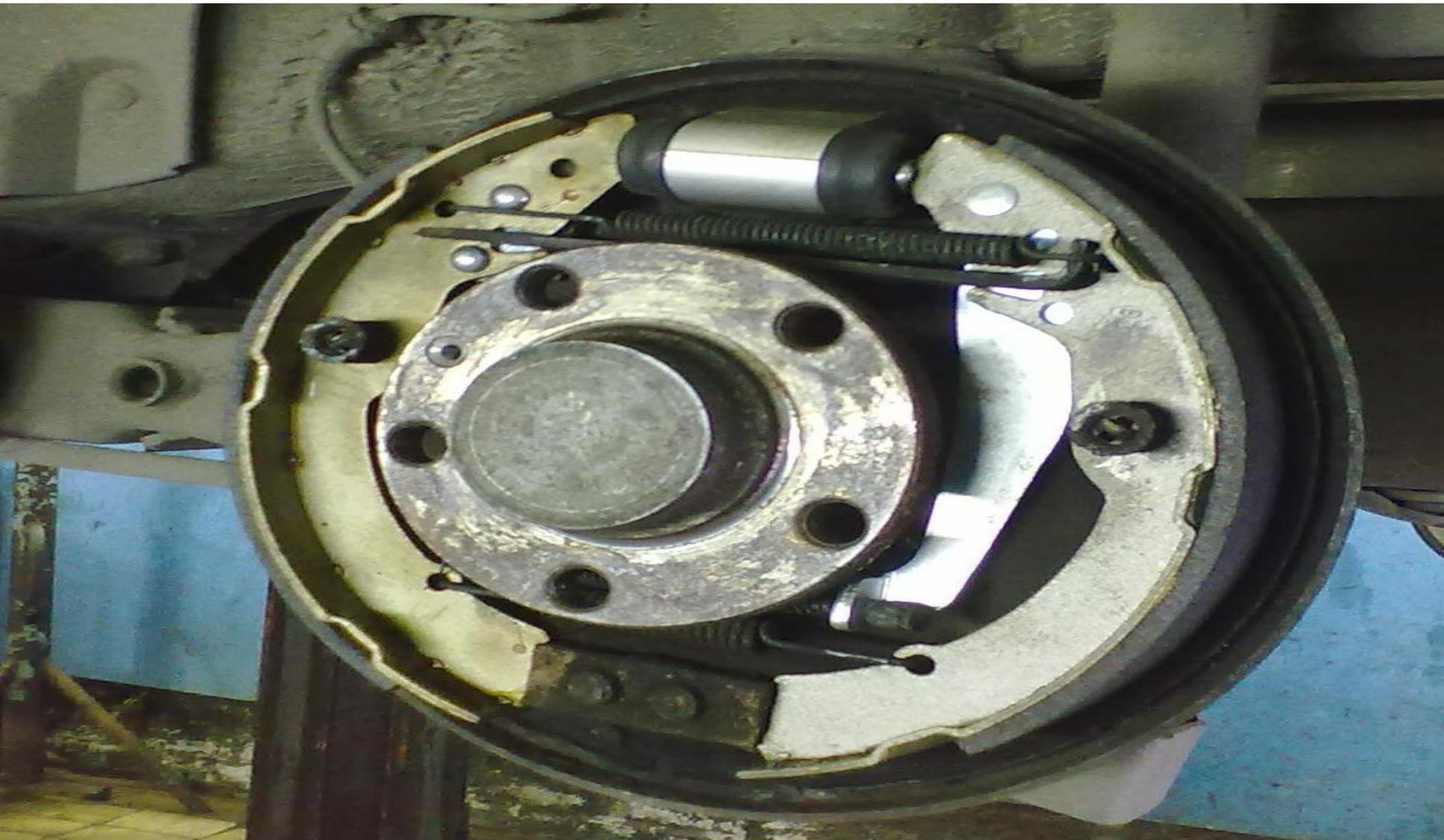
После диагностики тормозного барабана производится диагностика тормозного барабанного механизма, а именно:
