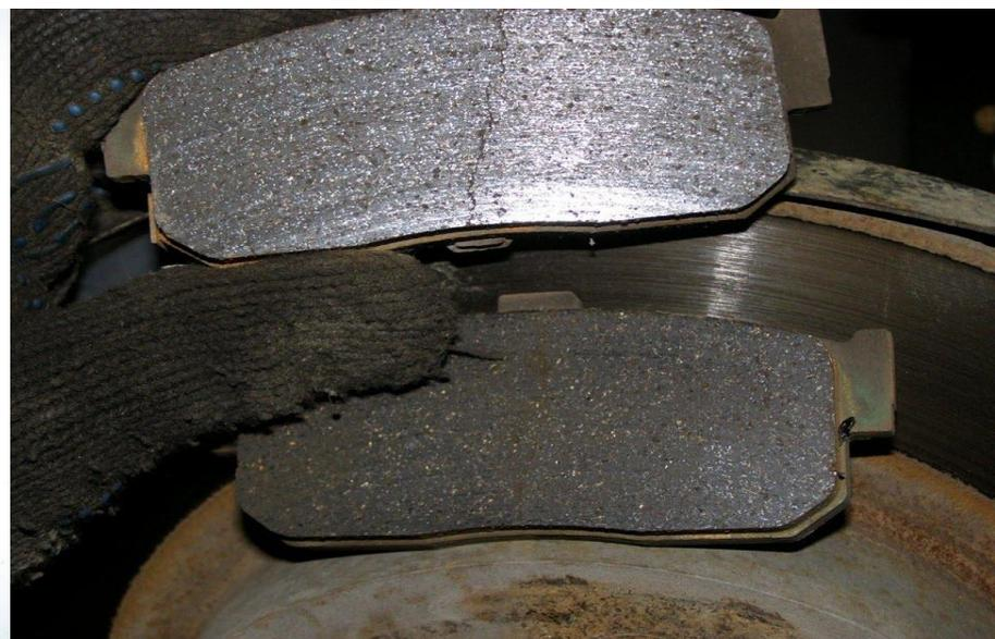
Измеряем толщину фрикционного слоя
