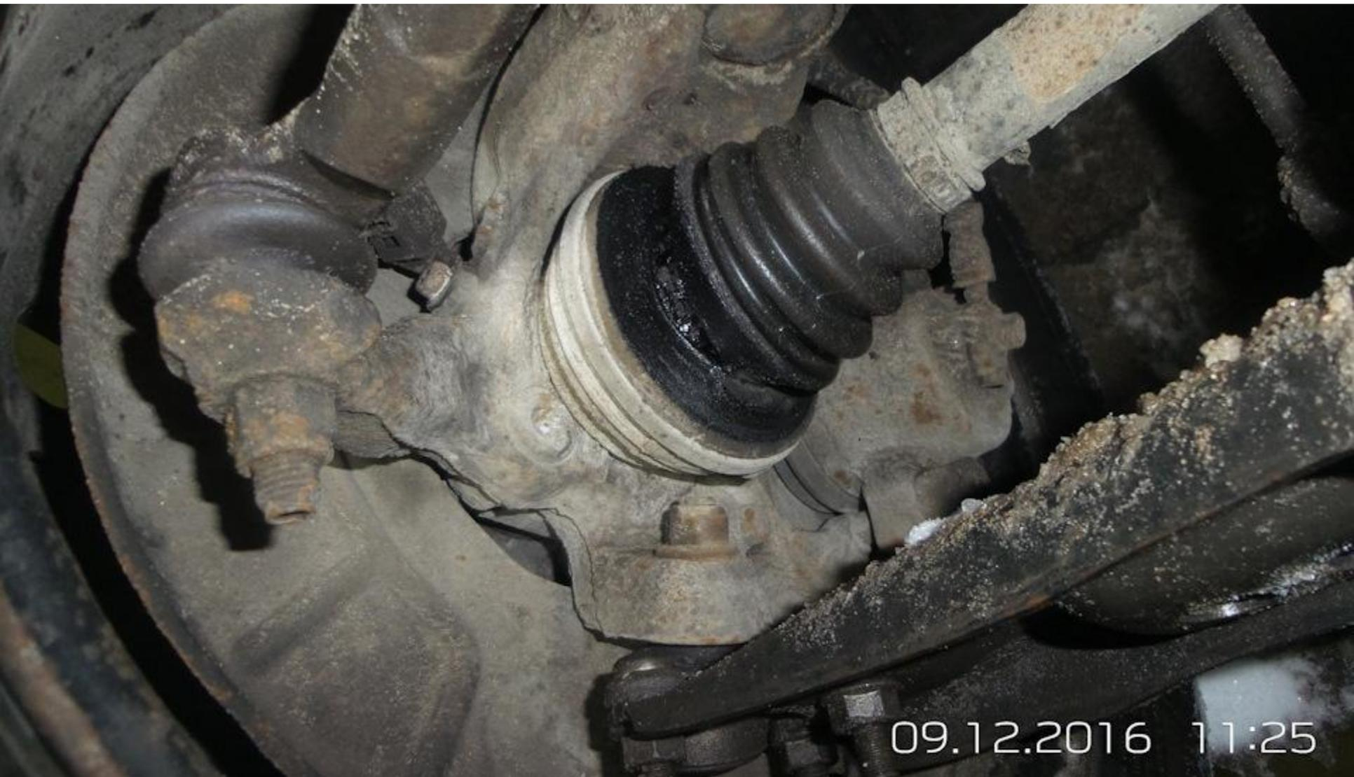
Далее проверяем, состояние шаровой опоры и ее пыльника, состояние, состояние саленблоков продольных рычагов и целостность их крепления
