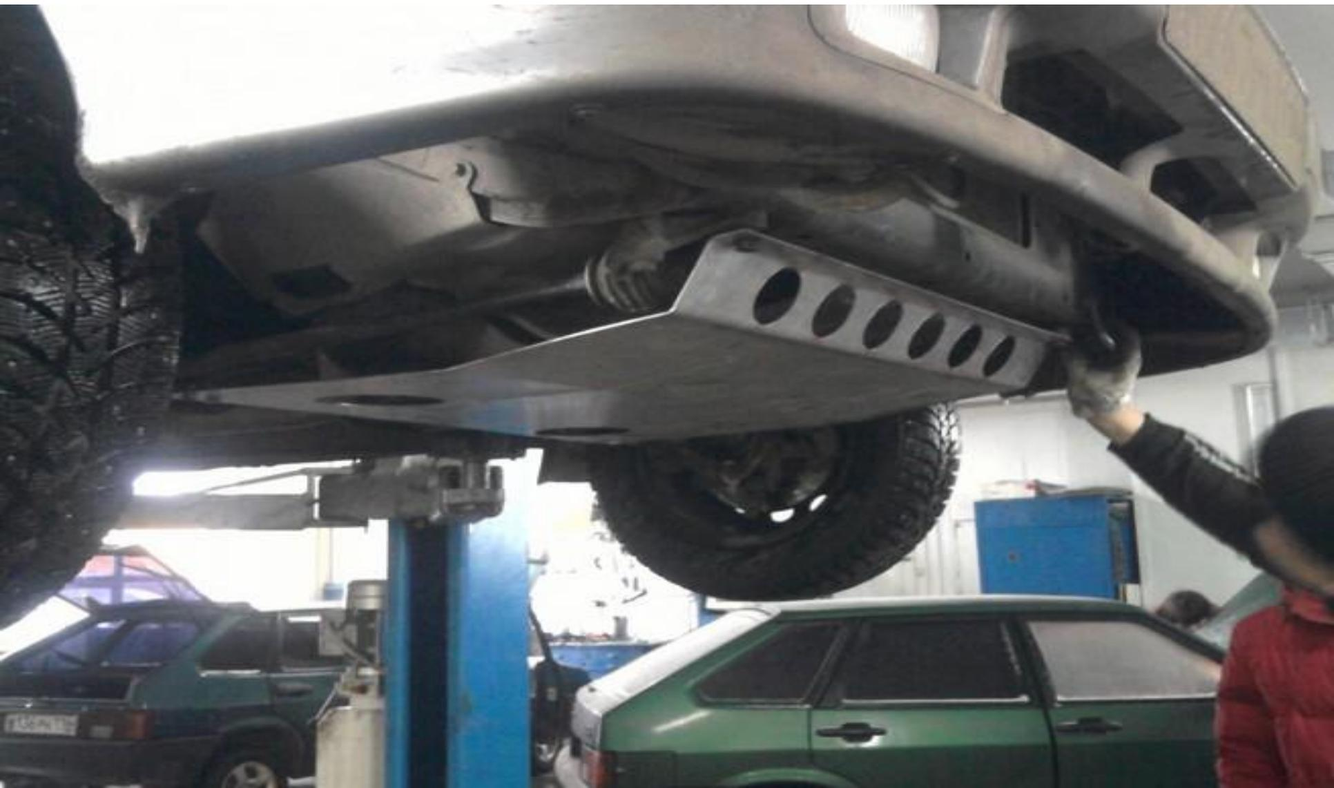
Проверяем правую стойку амортизатора, смотрим наличие подтеков масла, целостность пыльника амортизатора, целостность крепление амортизационной стойки сверху под капотом, с низу на поворотной цапфе, проверяем целостность пружины, крепление и износ рулевого пальца и его манжеты, м
