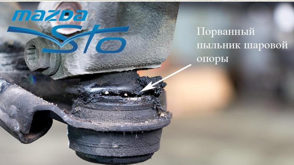
Порванный пыльник шаровой опоры
