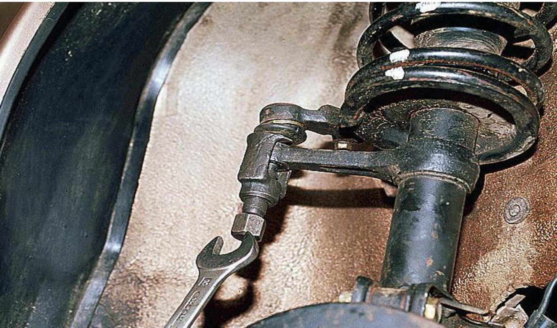
Далее проверяем, состояние шаровой опоры и ее пыльника, состояние манжеты ШРУСА
