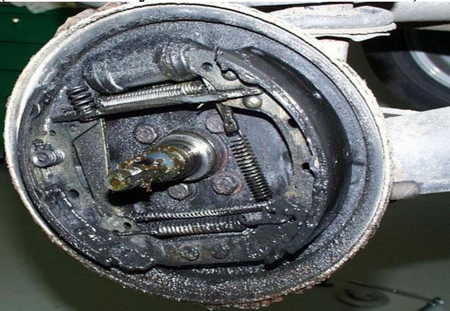
После диагностики тормозного барабана производится диагностика тормозного барабанного механизма, а именно:
