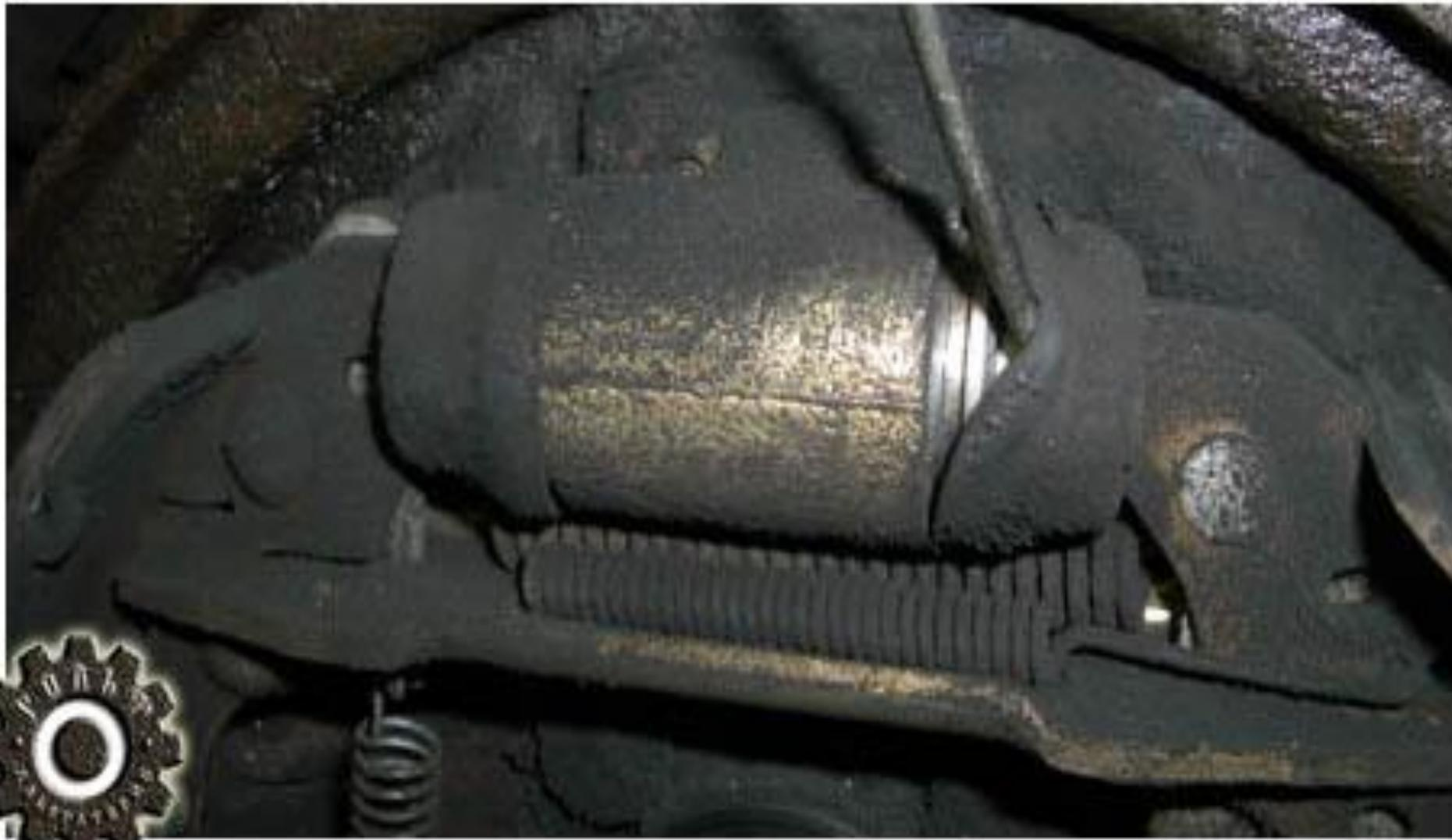
Если рабочий тормозной цилиндр не герметичен, тормозная жидкость подтекает то необходимо его заменить (в данном случае вместе с колодками)
