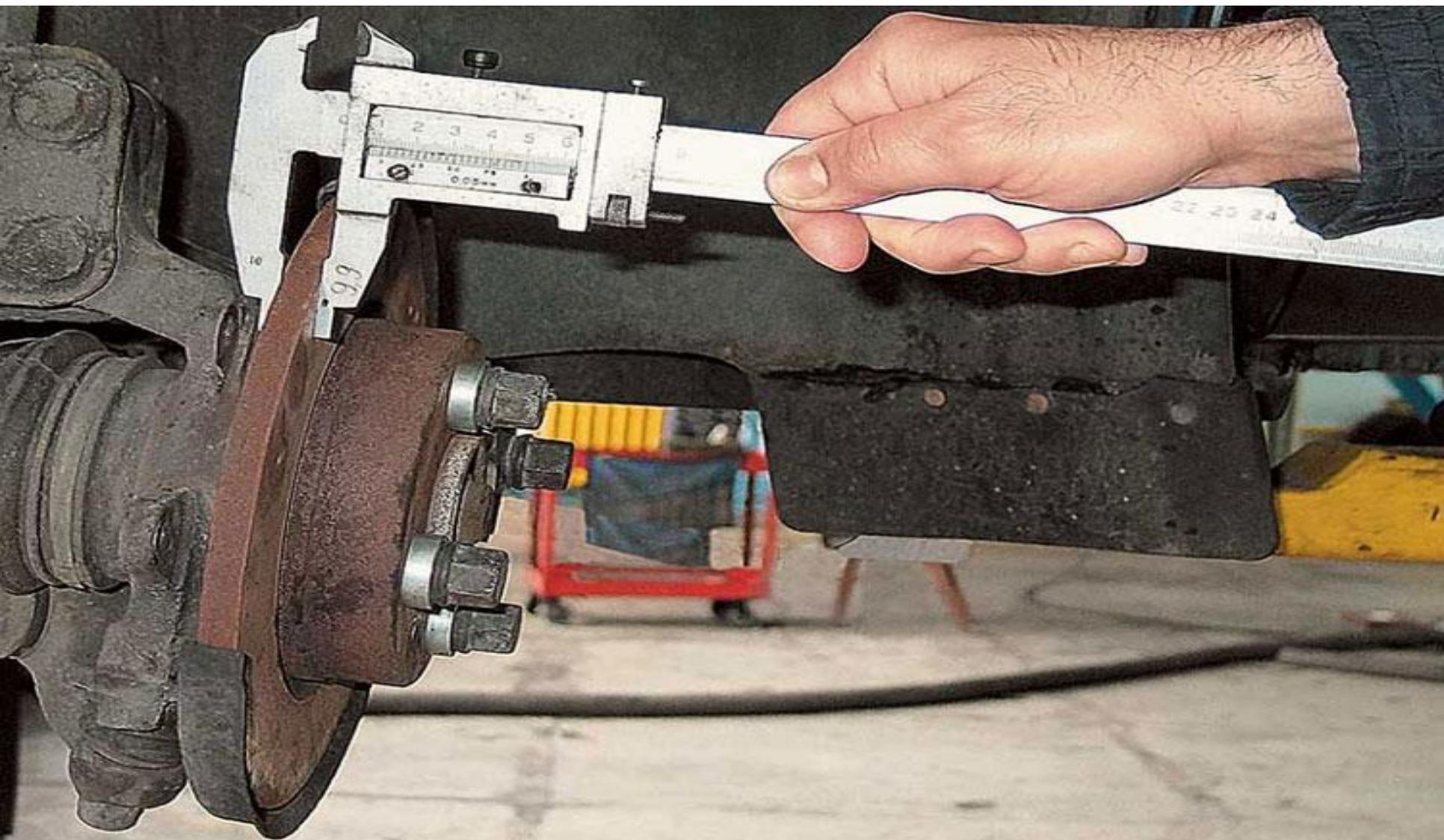
При выполнении измерений вы должны показать навыки и умения пользования измерительным инструментом штангенциркулем и микрометром
