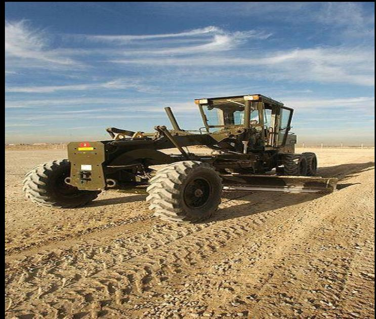
**Автогрейдеры** – землеройно-транспортные машины, имеющие объемный гидравлический привод регулировки положения отвала, могут оснащаться автоматическими системами нивелирования, применение которых облегчает работу оператора и позволяет добиться необходимых параметров профилируемой поверхности за меньшее число проходов грейдера, что повышает технико-экономические показатели машины.
