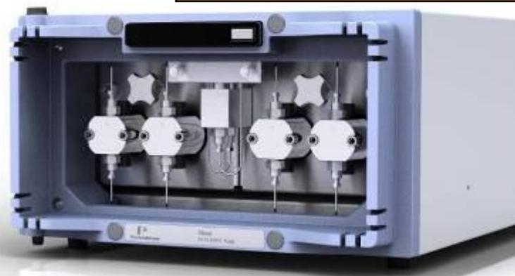
Клапаны высокого давления Ti-tip и демпферы пульсаций
