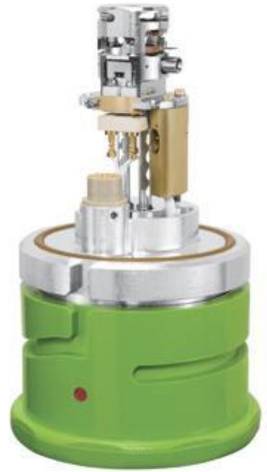
Электроспрей. После выхода из капилляра раствор превращается в заряженные микрокапли, после испарения из них растворителя капли сталкиваются с нейтральными молекулами газа и распадаются с образованием ионов
