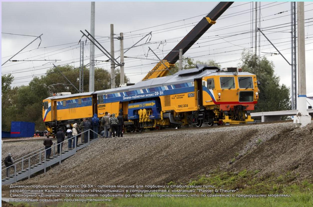
Динамик-подбивочный экспресс 09-3X - путевая машина для подбивки и стабилизации пути, разработанная Калужским заводом «Ремлутьмаш» в сотрудничестве с компанией "Plasser & Theurer". Самоходный «Динамик - 3X» позволяет подбивать до трех шпал одновременно, что по сравнению с предыдущими моделями, значительно повышает производительность.
