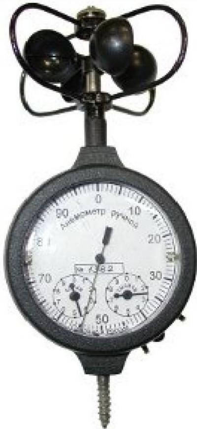
предназначен для измерения средней скорости направленного воздушного потока в промышленных условиях и средней скорости ветра на метеорологических станциях.
